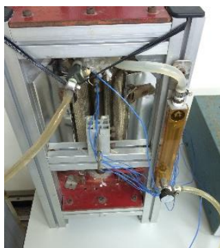
設備名稱：加熱測溫柱 設備用途：加熱試片、 測量溫度
